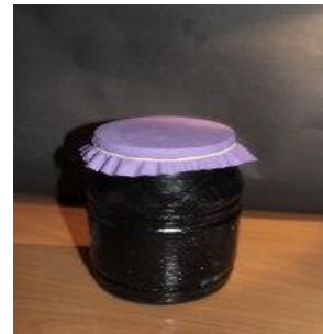
شكل (١) تونوسكوب (tonoscope) بسيط
