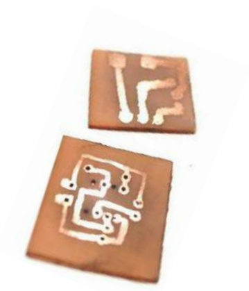
شكل (٨.٤) تفاعل النحاس مع كلوريد الحديد الثلاثي
