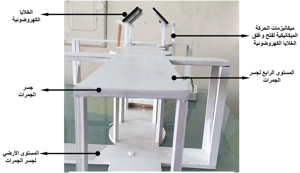
شكل رقم (٧) حركة الخلايا الكهروضوئية على طول جسر الجمرات أثناء الفتح والغلق عن طريق ميكانيزمات الحركة الميكانيكية
