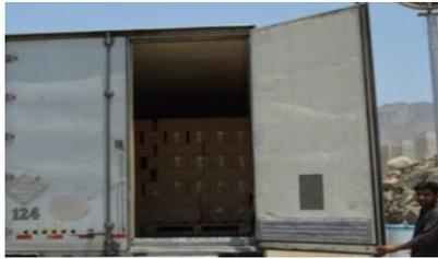
شكل رقم (6): عدم وجود ستائر بلاستيكية أو هوائية عند الابواب
