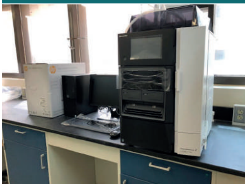
جهاز الفصل الكروماتوجرافي عالي الكفاءة
